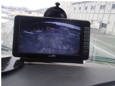
写真 6-16 GPS を使用した安全運転支援システム
